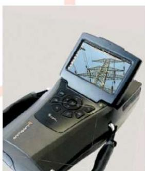
Luminar HD เป็นเครื่องทดสอบ Corona ที่มีประสิทธิภาพสูงสามารถตัดสินใจได้ทั้งกลางวัน และกลางคืนมาพร้อมกับภาพและวิดีโอที่คมชัดระดับ HD โดยเครื่องมือที่มีประสิทธิภาพด้วยเทคโนโลยี DayCor สามารถระบุตำแหน่งของการทดสอบได้ด้วยระบบ GPS .
