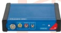
FRANEO 800 คืออุปกรณ์ตรวจทดสอบความผิดปกติใน power transformer windings และความบกพร่องใน magnetic core หลังการขนส่งหน้าจอเปลี่ยนจากโรงงานไปที่หน้างาน หรือตรวจทดสอบความผิดปกติของหน้าจอเปลี่ยนหลังการเกิด fault ด้วยหลักการ sweep frequency
